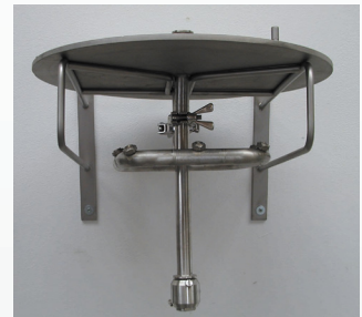
(2) Couvercle de lavage mis en place manuellement sur le conteneur
