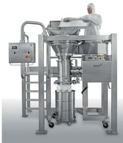
Installation de déchargement et concassage/broyage combiné
