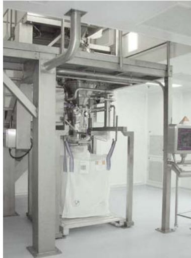
Installation de conditionnement en Big Bag combinant déchargement de sécheur, broyage et dosage
